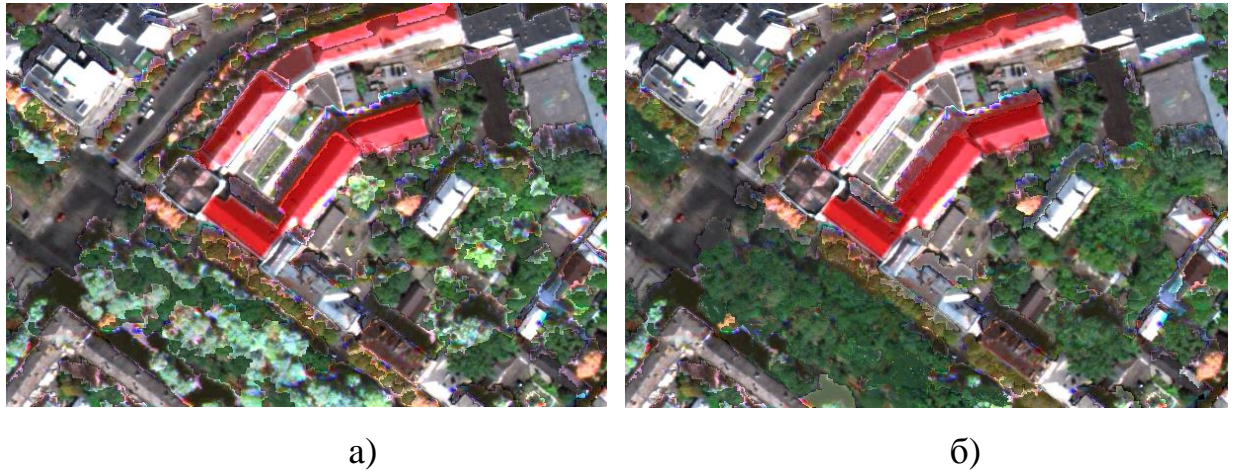
Рисунок 3.27 – Результат компенсації тіні без пошуку парних сегментів (а), та з пошуком парних сегментів (б)
