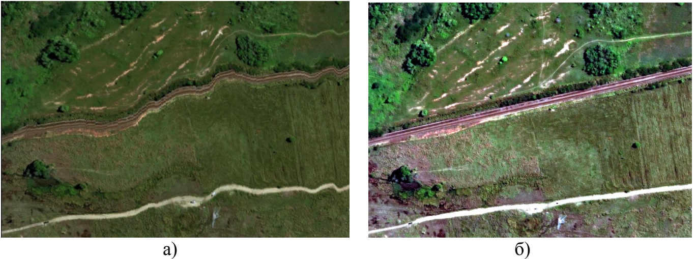
Рис. 13. Некоректоване зображення, отримане поздовжнім ППЗ-сканером (а); зображення, яке пройшло геометричну корекцію (б)
